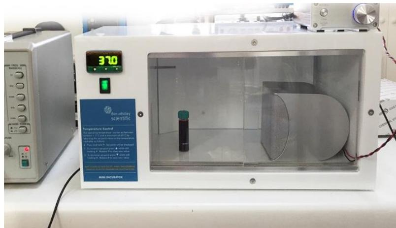
**Рис. 6.** *Лабораторный инкубатор Cytoscope с пробиркой, содержащей кровь, и динамиком*
